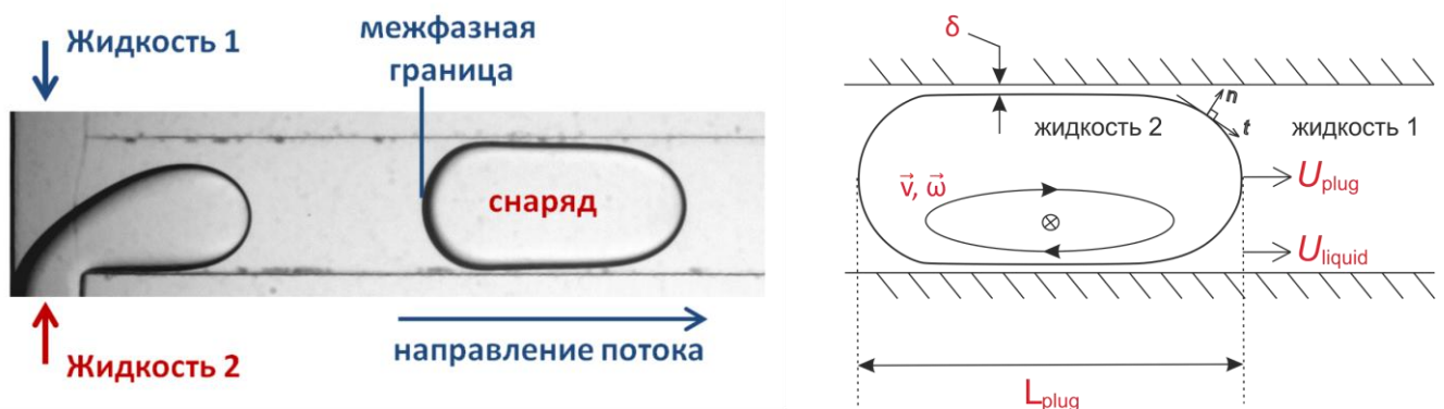
Рисунок 1.3.1 – Характерная картина формирования и схема снарядного режима течения в Т-образном микроканале.
